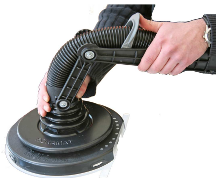
3. Przesunąć dźwignię do przodu w celu zablokowania śrub
